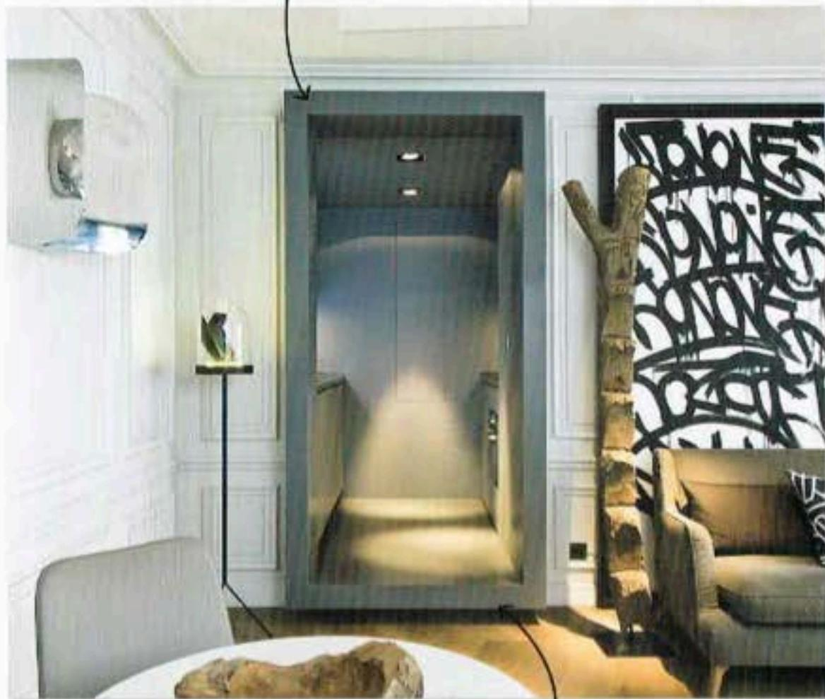
*L'entrée de la cuisine est encadrée comme le serait un tableau accroché au mur – un résultat obtenu grâce à la surélévation du sol et l'abaissement du plafond de la cuisine. L'un et l'autre sont respectivement surélevé et abaissé d'environ 18 cm, de façon à créer une parfaite symétrie.*
